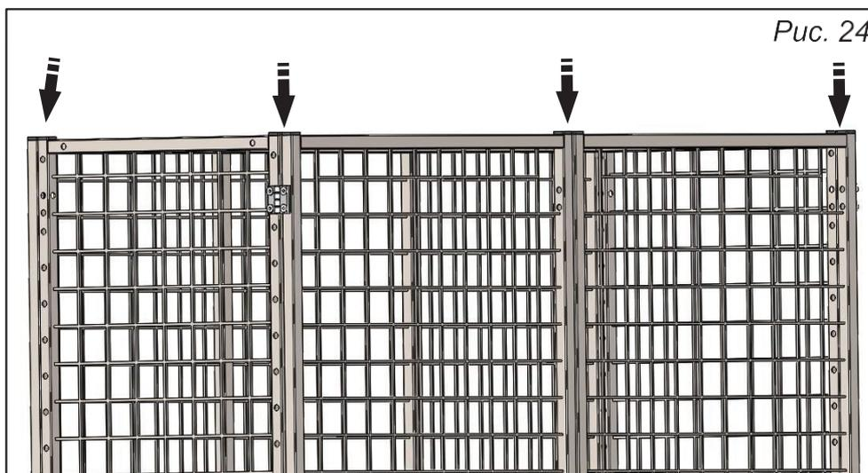
**8. В ПОСЛЕДНЮЮ ОЧЕРЕДЬ НА СОБРАННОМ СТЕЛЛАЖЕ С ПОМОЩЬЮ ИНСТРУМЕНТА ЗАТЯНУТЬ ВСЕ РЕЗЬБОВЫЕ СОЕДИНЕНИЯ.**
