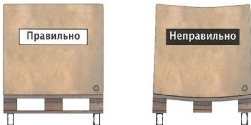
Рис. 2. Установка поддона на стеллаж
