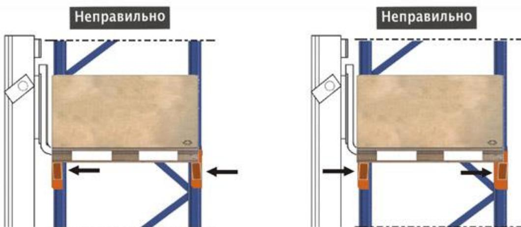
Рис. 11. Искривление балки в результате волочения или толкания груза при его установке и/или снятии ,
