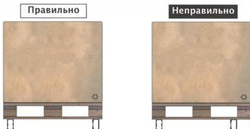
Производить нагрузку на стеллажное Оборудование, необходимо начиная с нижних ярусов, для того чтобы во время загрузки секции стеллажа, центр тяжести находился в наиболее её низкой части (рис. 7).
