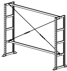
При помощи талрепов, болтов M10x20 и гаек M10 установить стяжки по диагонали.
