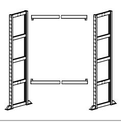
Соединить стойки патерностера поперечными балками используя болты M10x70 и гайки M10.
